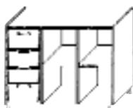
Schrank mit 4 Schüben links und 2 Einlegeböden rechts, Mittelwand
