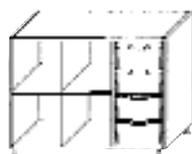
Schrank mit 4 Schüben rechts und 2 Einlegeböden links, Mittelwand
