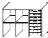
Schrank mit 8 Schüben rechts und 2 Einlegeböden links, Mittelwand
