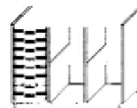
Schrank mit 8 Schüben links und 2 Einlegeböden rechts, Mittelwand
